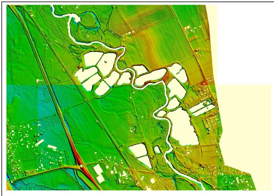
Figure 5: Exemple de zones remblayées (couleur sable) en amont de l'agglomération troyenne. Source : Grand Troyes
